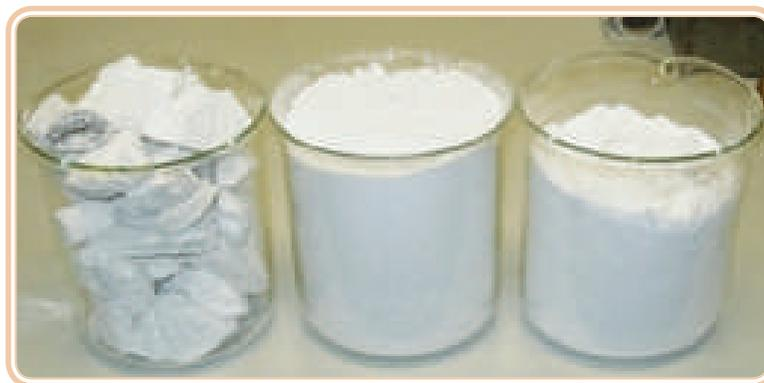
**Figura 2.3: Rendimento da cal virgem na obtenção da cal hidratada**
