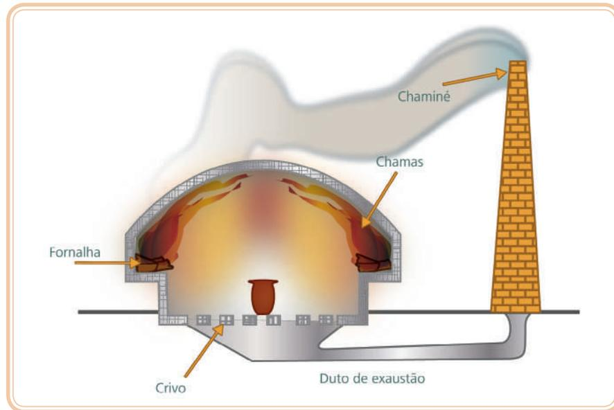
**Figura 6.10: Forno intermitente de chama invertida – caipira**
