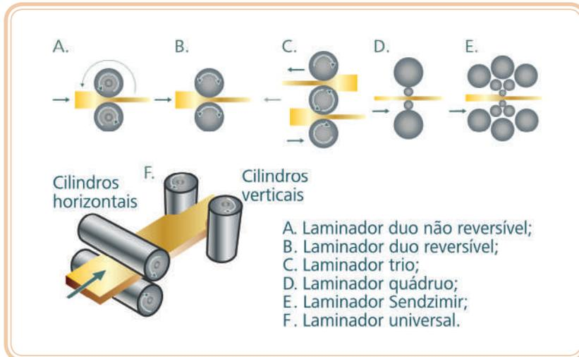
**Figura 5.6: Esquema de vários tipos de laminadores**
