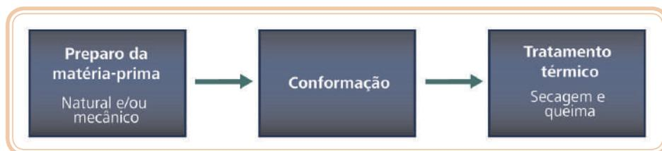
**Figura 6.1: Diagrama esquemático do processo de fabricação do material cerâmico**
