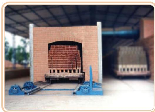
**Figura 6.6: Túnel de secagem**
