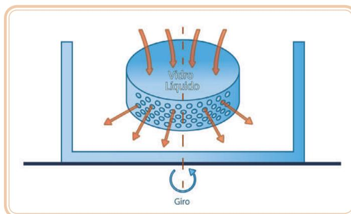
**Figura 7.9: Esquema de fabricação da lã de vidro**
