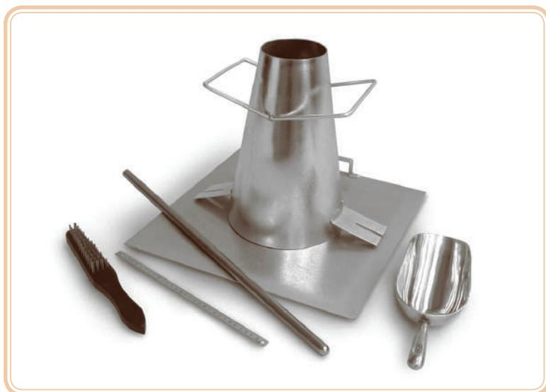
**Figura 4.1: Mecanismos para determinação do *slump test***
