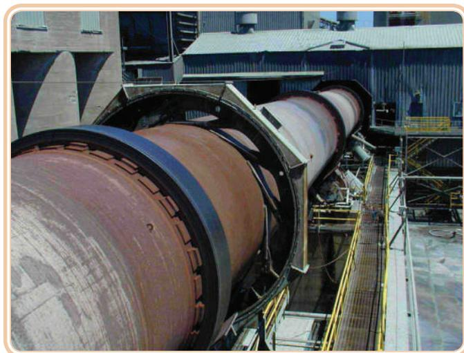
**Figura 2.1: Forno rotativo para obtenção da cal virgem**
