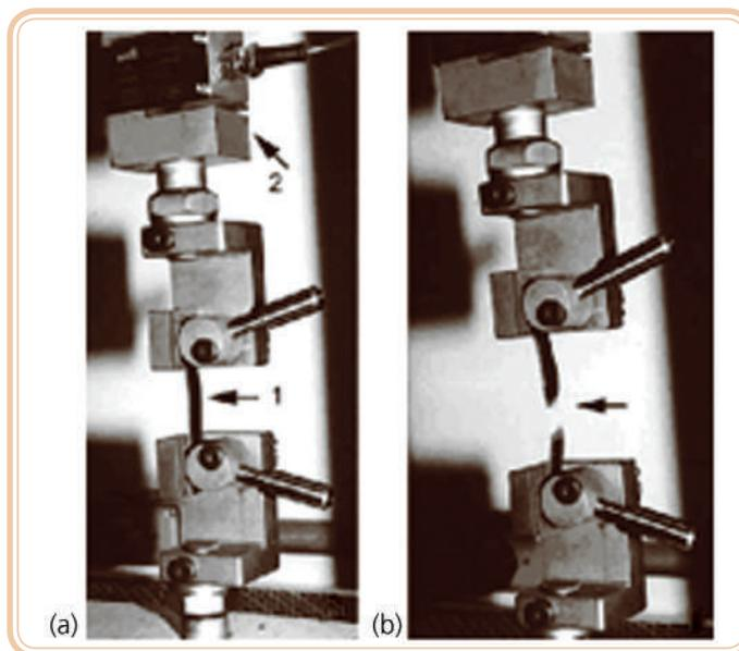
**Figura 5.20: (a1) Amostra de aço sendo traçada, (a2) garras da prensa e (b) ruptura do corpo de prova**
