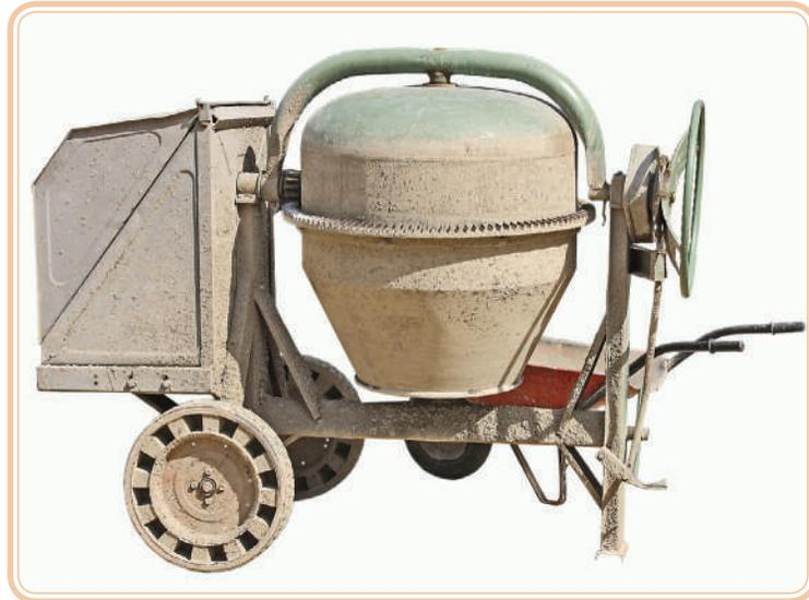
**Figura 4.5: Betoneira de mistura por gravidade**
