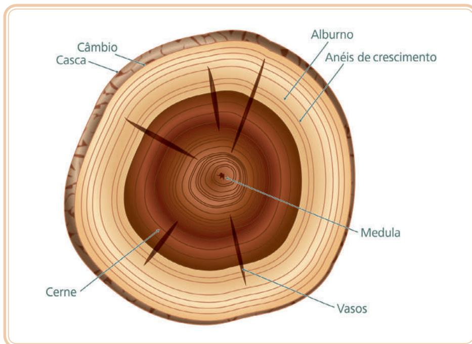
**Figura 10.1: Seção típica de um tronco de árvore**
