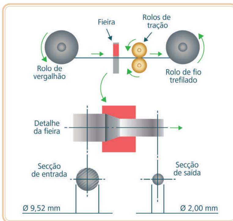
**Figura 5.15: Esquema de fio sendo trefilado**
