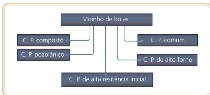
**Figura 2.6: Tipos de cimento Portland após moagem nos teores de respectivas matérias-primas**
