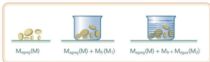
**Figura 3.5: Esquema de procedimentos para determinação da massa específica de agregado**
