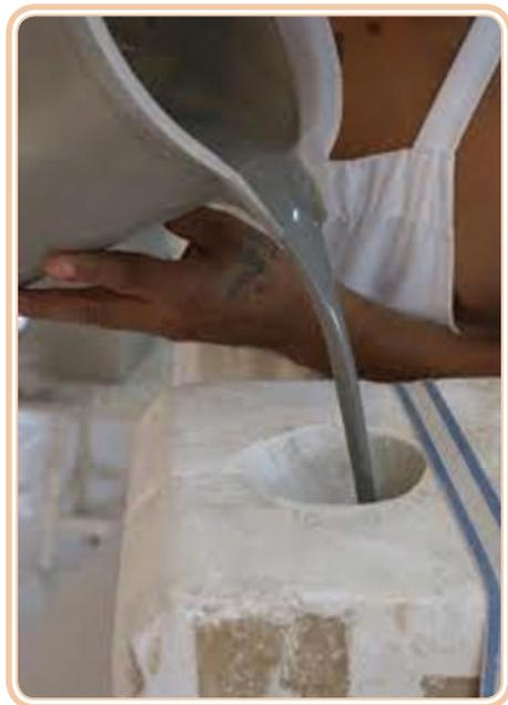
**Figura 6.3: Argila fluida sendo vertida no molde**
