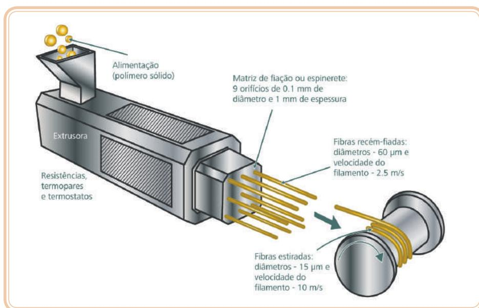
Figura 8.4: Esquema de equipamento de fiação de um polímero
