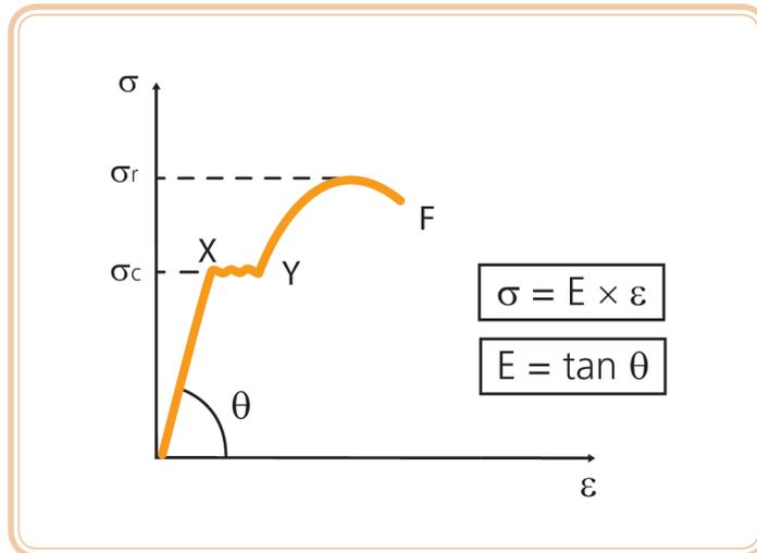
**Figura 5.18: Gráfico tensão-deformação apresentando patamar de escoamento**
