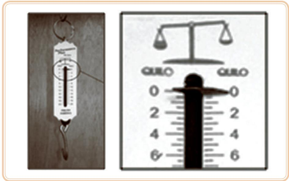
**Figura 1.2: Dinamômetro e seu detalhe**
