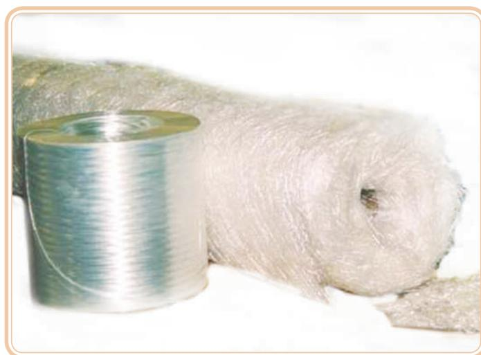
**Figura 7.8: Fibra de vidro (roving) e em manta**
