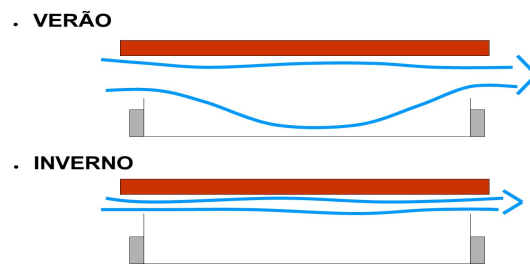
Figura 17. Efeito da ventilação térmica e higiênica
