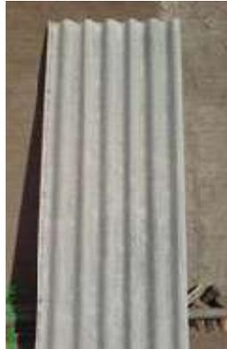
Telha de fibro-cimento (aparentemente igual à de cimento-amianto)
