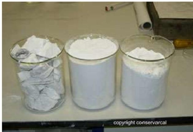
Calcário, cal hidráulica e cal hidratada
