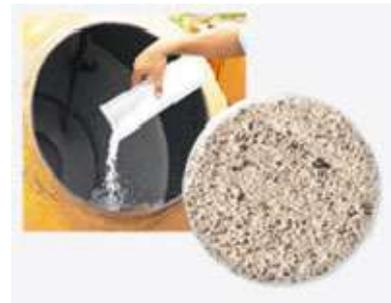
Aditivos sólidos e líquidos e sua aplicação ao processo de fabricação do concreto
